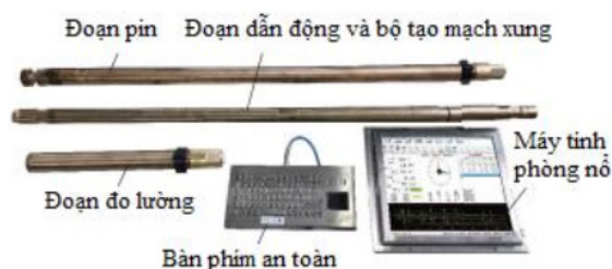
Hình 3. Hệ thống đo lường khi khoan không dây mạch xung bunn khi dùng cho mỏ ZSZ2000
