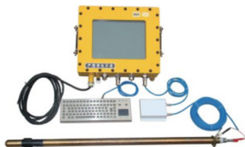
Hình 2. Hệ thống đo lường trong khi khoan chuyên dùng cho mỏ ZSZ1000 dựa trên kỹ thuật cấp điện bên ngoài lỗ khoan
